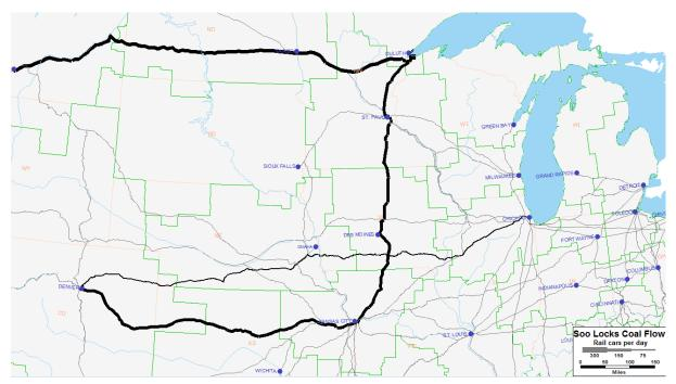
FIGURE 34—RAIL TRAFFIC FOR COAL PRIOR TO A POE LOCK SCENARIO CLOSURE
